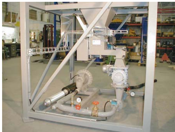
Projekt Rönnskärsverken i Skellefteå. Anläggning för dosering och pneumatisk transport av aktivt kol för rökgasrening.
