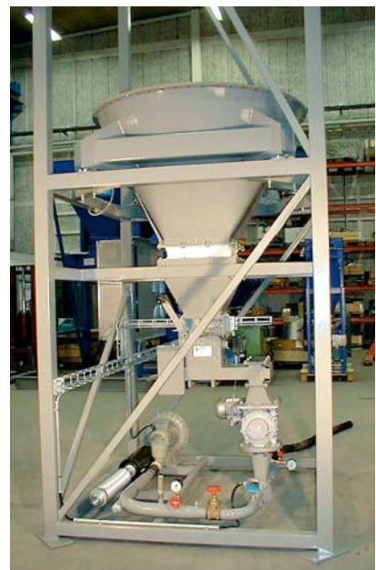
Injicering av aktivt kol i en rökkanal för reduktion av dioxiner och kvicksilver vid Boliden Mineral kopparsmältverk. Nyckelfärdig anläggning som består av storsäckstömmare, doserare, pneumatiskt transportsystem, injiceringslans och el-skåp.
