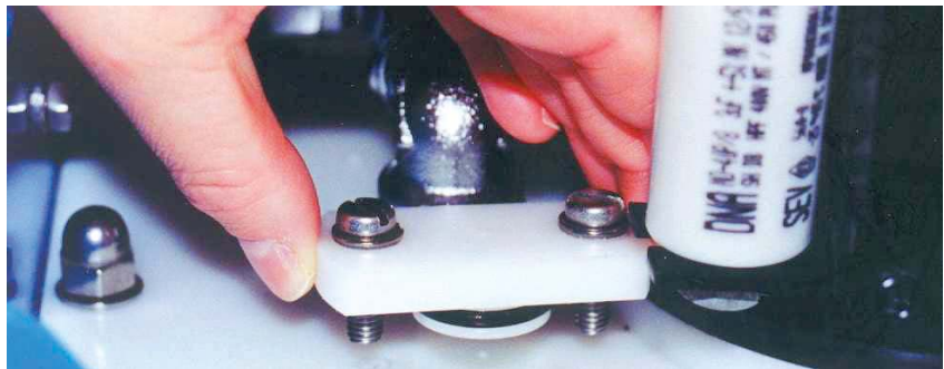
Leicht zugängliche Einspritzdüse für das Polymerkonzentrat
