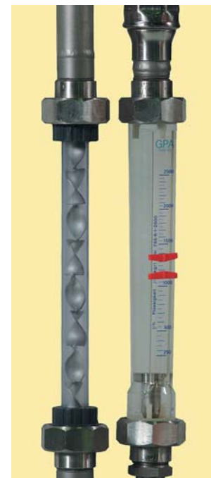
Statischer Mischer und Verdünnungswasser Messung
