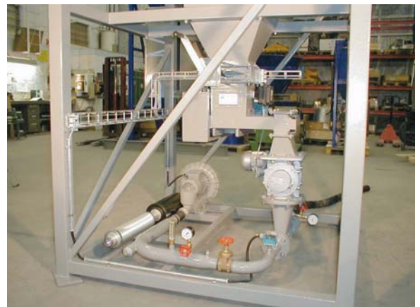
Projekt Rönnskärsverken in Nordschweden. Anlage für Dosierung und pneumatische Förderung von Aktivkohle für Rauchgasreinigung.
