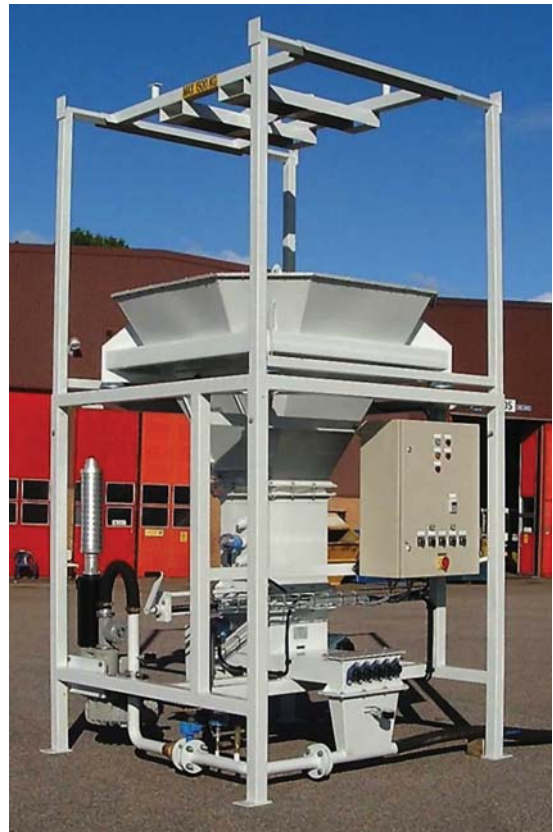
Projekt Larvik. Big-Bag Entleerer mit Dosierausrüstung für pneumatischen Transport von Kalk für die Rauchgasreinigung
